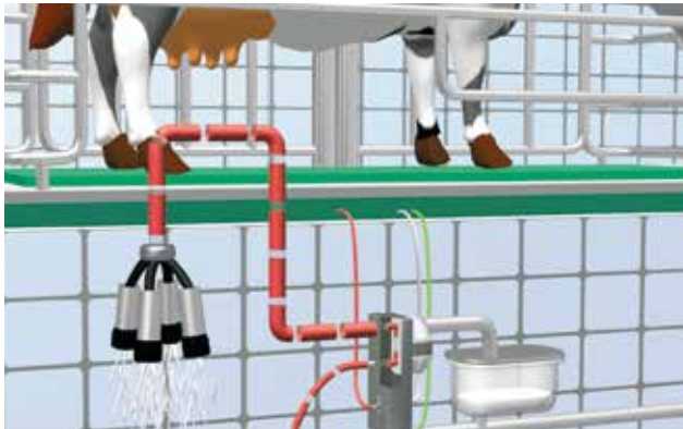
Desinfectiefase in het BackFlush-systeem
