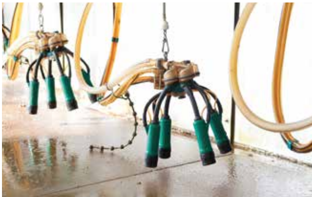
GEA combineert in haar Apollo Melk Systeem de backflush met het dippen in de beker. Hiermee worden deze handelingen in de melkstal geautomatiseerd en de melker uit handen genomen.
